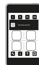
LED indikačné svetlo na toalete s integrovanou bidetovou sprškou svieti načerveno. Na diaľkovom ovládači sa zobrazuje hlásenie «Descaling required».
