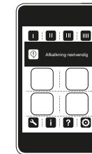
LED-indikatorlyset på toilettet med vaskefunktion lyser rødt. Fjernbetjeningen viser «Afkalkning nødvendig».
