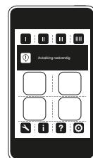
LED-indikatorlyset på dusjotaletet lyser rødt. Fjernkontrollen melder «Avkalking nødvendig».
