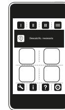
El indicador LED del inodoro bidé se ilumina en rojo. El mando a distancia muestra el mensaje «Descalcific. necesario».
